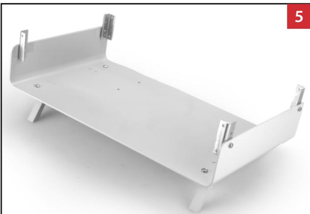
4x Alu-Winkel mit 4x Linsenkopfschraube Torx M3 x 10 mm auf die untere Gehäuseschale anschrauben. Ein Torx-Winkelschraubendreher (T10) liegt bei. Die gewindefurchenden Schrauben mit «Gefühl» anziehen.
