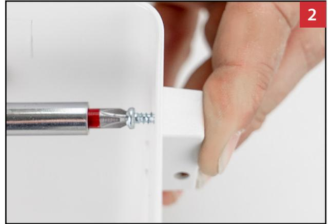
4x Kunststofffüsse mit 4 x Linsenkopfschraube für Kunststoff M3 x 10 mm anschrauben.
