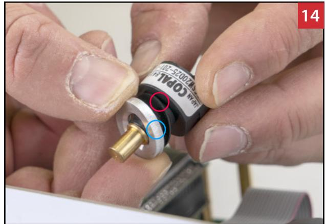
Zwischen Frontplatte und Encoder kommt die Gummi, und Alu-Unterlegscheibe M10 x 3 mm.
