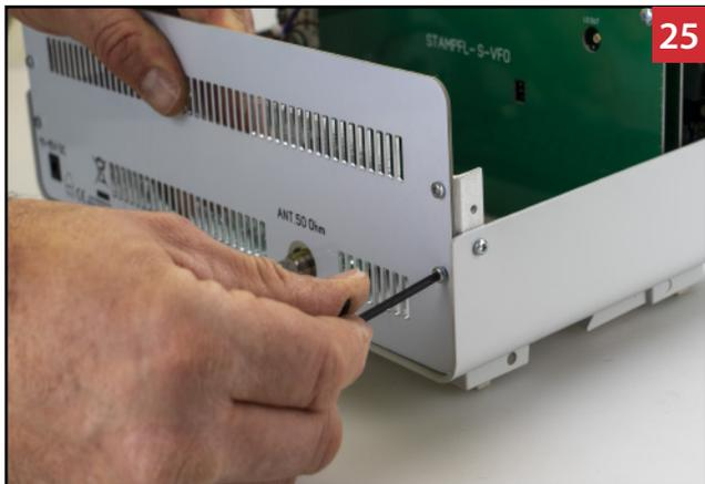
Gehäuserückseite mit 4x Linsenkopfschraube Torx M3 x 10 mm festschrauben.
